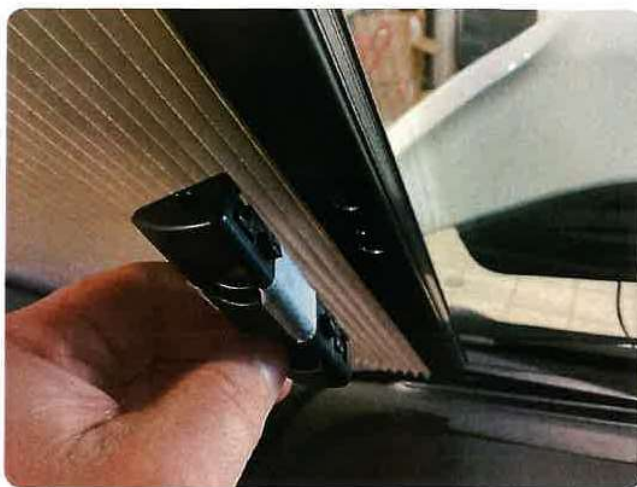
9.12 Solskjerming skadet/defekt Løst håndtak solgardiner venstre fram. Kan limes
