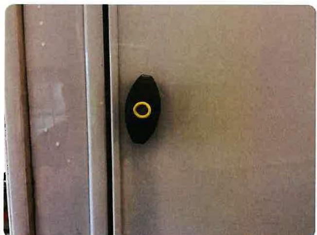
2.5 Låsesylinder defekt Mangler låsesylinder lasteluke høyre bak
