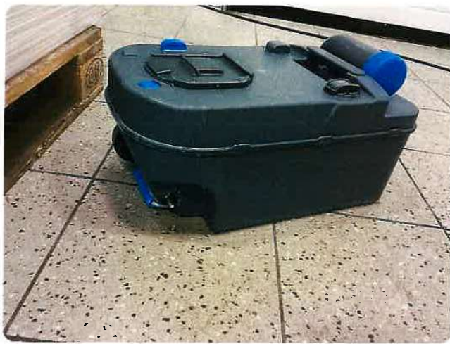
9.6 Sprekk/skadet toalett Defekt toalett kasett
