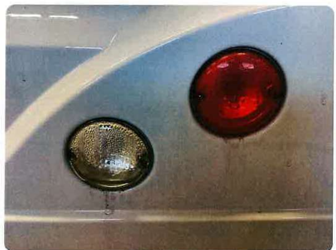
3.1 Fukt Sprekke/ fukt i 4 baklys
