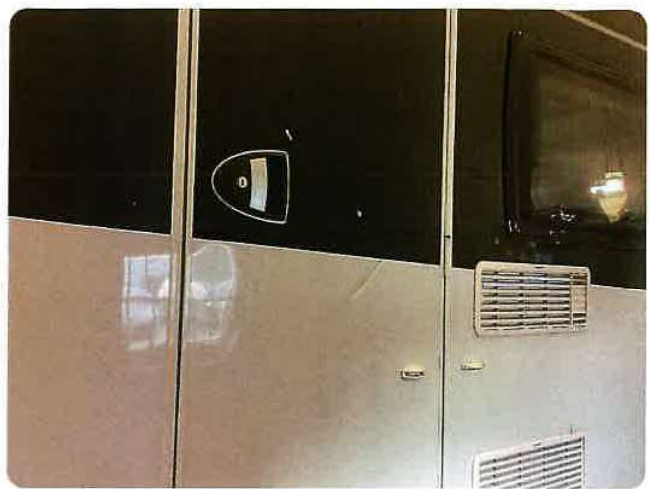
2.3 Bulk med lakkskade Dør må event sparklet + lakkeres. Ny dekal monteres.
