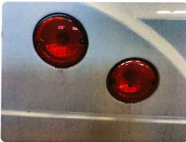
3.1 Fukt Sprekke/ fukt i 4 baklys
