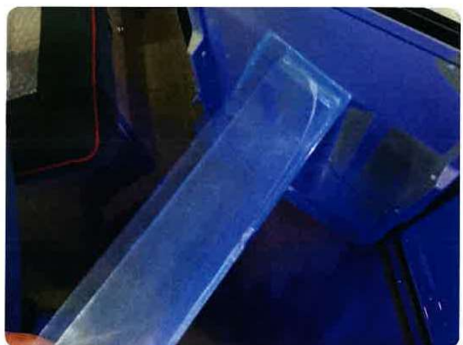
9.1 Øvrige feil Sprukket hylle kjøleskap
