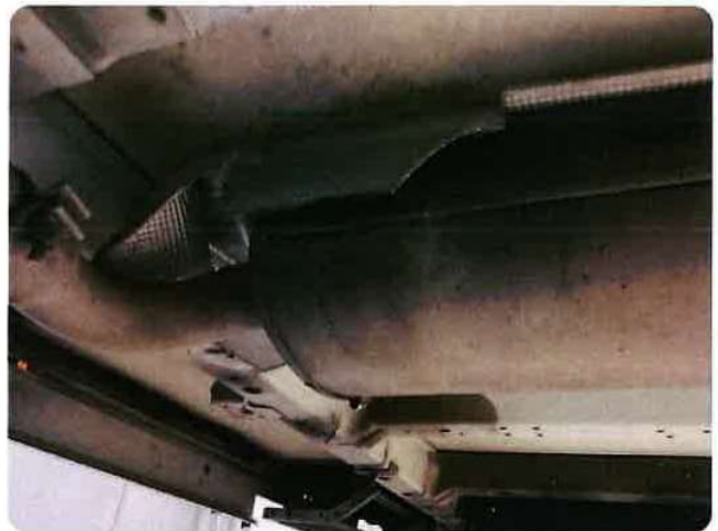
2.2 Beskyttelsesplate skadet/mangler Defekt eksoskjold
