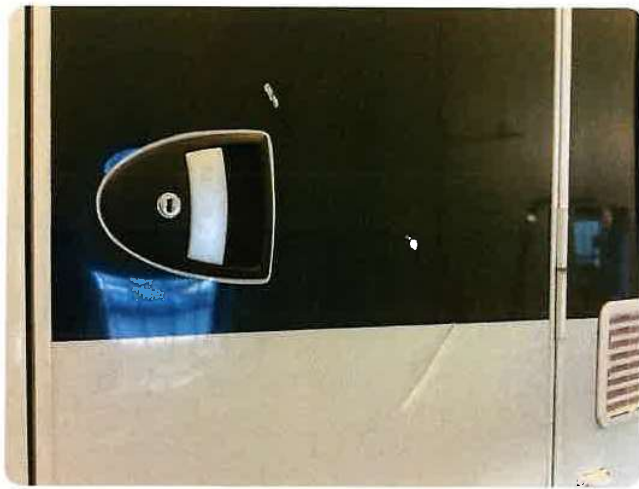
2.3 Bulk med lakkskade Dør må event sparklet + lakkeres. Ny dekal monteres.
