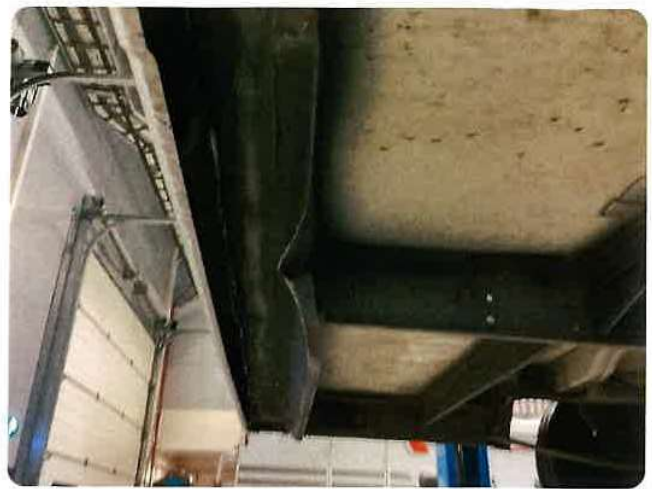
2.7 Skadet Skadet bjelke bak på bilen. Tror den kan demonteres, rettes, lakkeres og limes på nytt.
