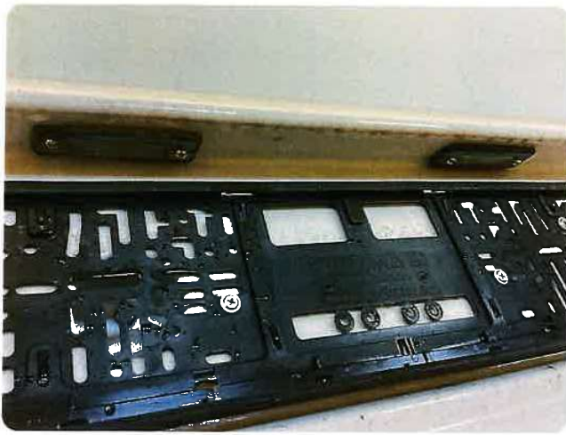
3.2 Skiltlys- defekter Mangler biter av skiltlys begge bak
