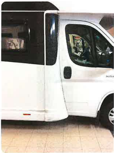
2.2 Bulk med lakkskade Må skiftes sideskjørt h/s + b-stolpedeksel. Ny dekal monteres
