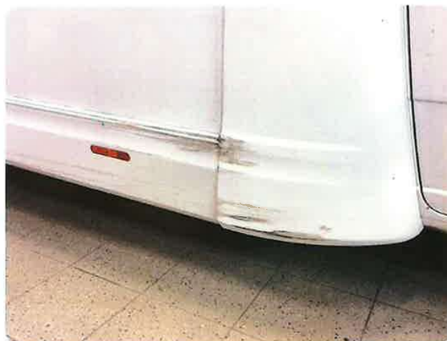
2.2 Bulk med lakkskade Må skiftes sideskjørt h/s + b-stolpedeksel. Ny dekal monteres
