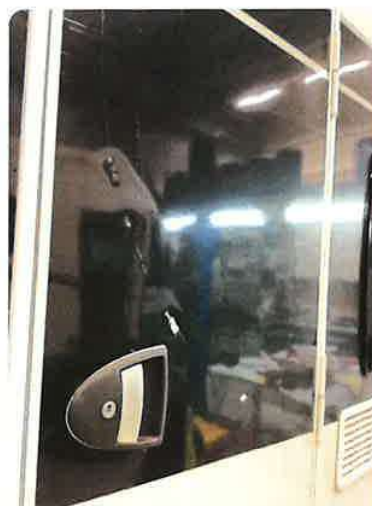
2.1 Bulk med lakkskade Skade kan repareres. Event sjekk opp mot pris på ny dør. Ny dekal må til.
