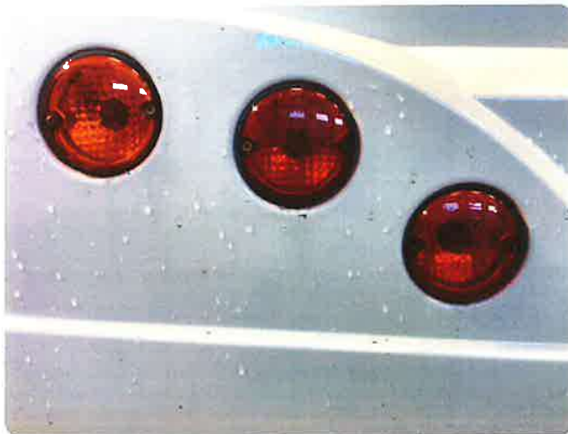
3.1 Defekt / sprukket glass Fukt/sprekker i flere av baklyktene.
