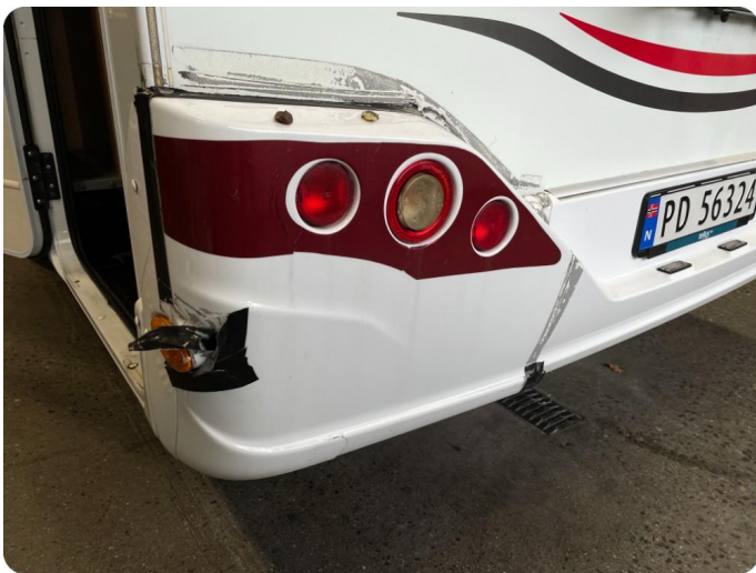
2.2 Skade Støttefanger bak alle tre deler ødelagt. List under lasteluke V.S. ødelagt. Mulig forsikring sak, påkost blir redusert i kr 0,-
