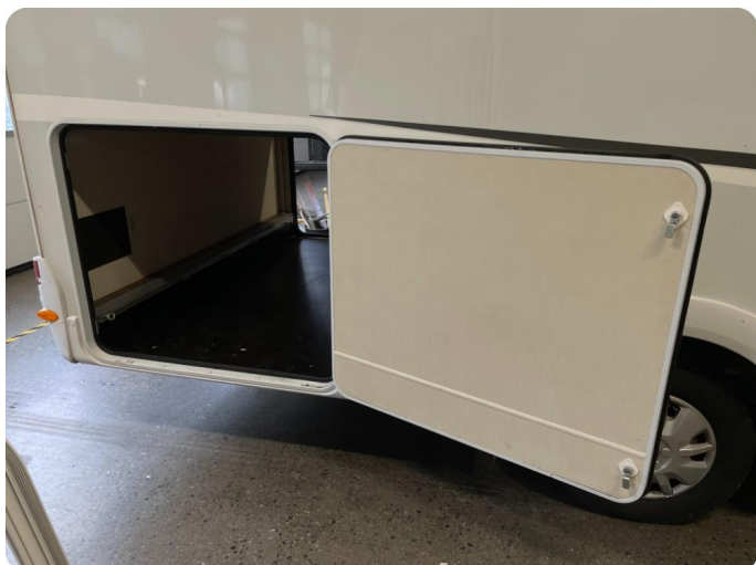
1 Målt fukt i % 99 Bunn ti lasteluke synlig skade.
